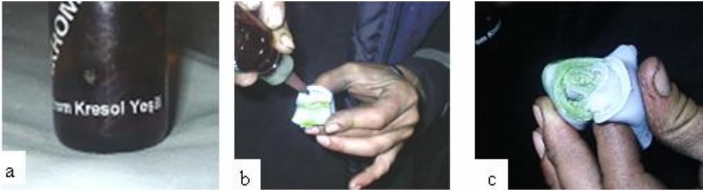
Resimler 1.4: a) İndikatör b) Deriye tatbik etme c) Derinin alacağı renk
