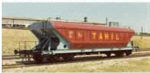
Resim 2.7: Uadgs Tipi tahıl vagonu
