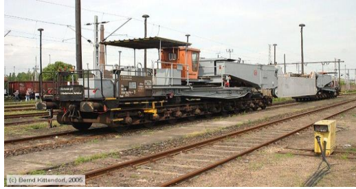
Resim 2.6: Uaais Tipi ağır yük vagonu
