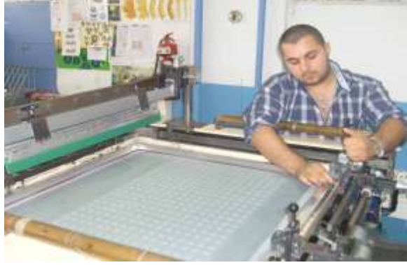
Resim 2.5: Serigrafi baskı kalıbının takılması
