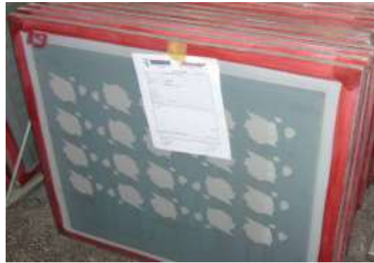
Resim 2.7: Vernik baskısı için hazırlanmış zemin kalıbı
