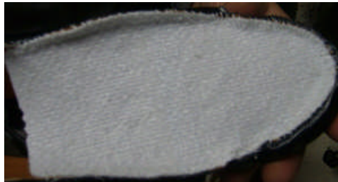
Şekil 2.10: Strobel makinesinde dikilerek birleştirilmiş saya ve vizoteks
