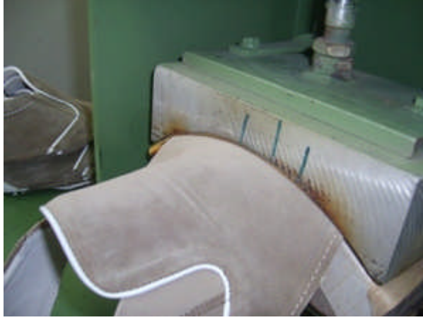
Fotoğraf 2.2: Buhar makinesinde yumuşatma işlemi
