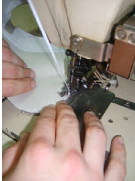
Fotoğraf 2.3: Büzme işleminin yapılışı
