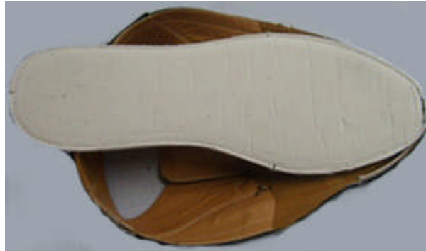
Fotoğraf 2.6: Burun bölgesinde çatılmış saya ve vizoteks
