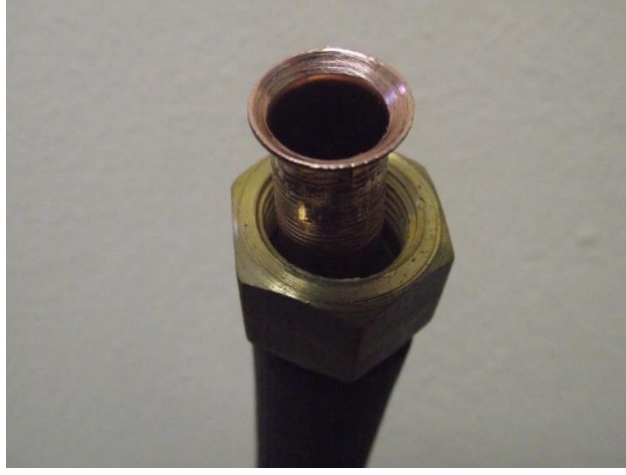
Resim 4.4: Havşası açılmış bakır boru
