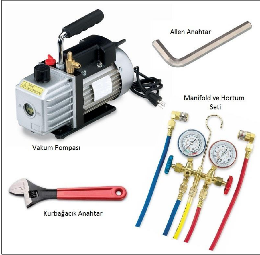
Resim 6.1: Klimaların vakumlanmasında kullanılan malzemeler
