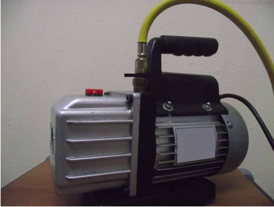
Resim 6.7: Vakum pompasına manifold hortumunun bağlanması
