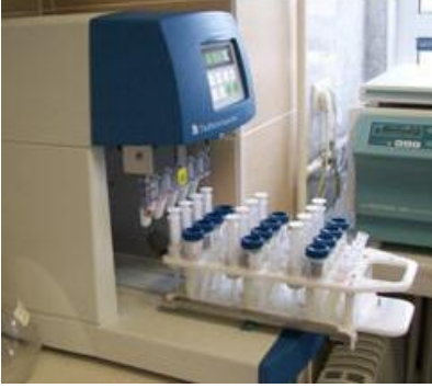
Resim 3.29: Prep mate tepşinin yerleştirilmesi
