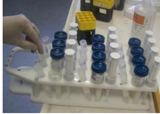
Resim 3.28: Prep mate tepsisine tüp, vial ve enjektörlerin yerleştirilmesi
