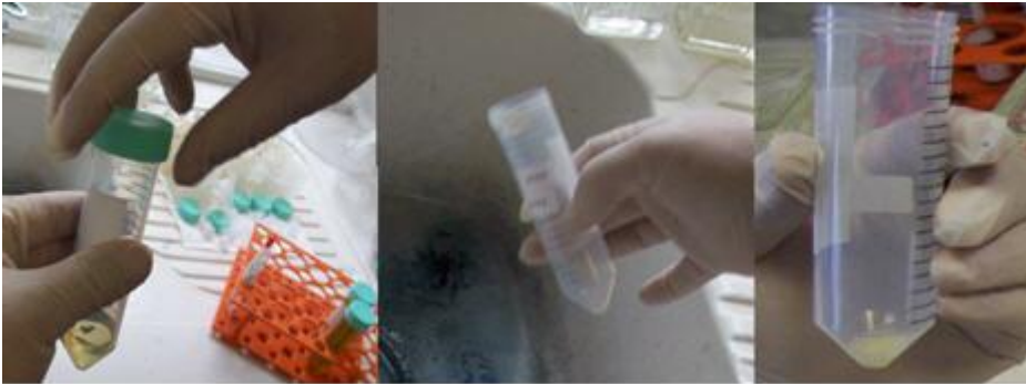
Resim 2.31: Hücre sedimenti elde edilmesi
