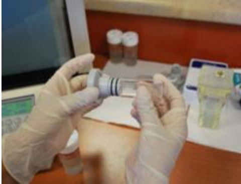
Resim 3.8: Filtrenin filtre başlığına takılması
