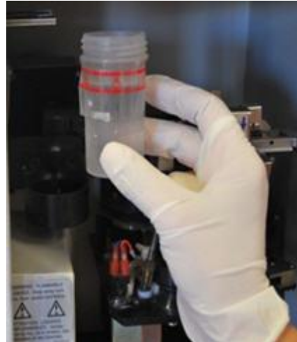
Resim 3.12: Fiksasyon kabının cihaza yerleştirilmesi
