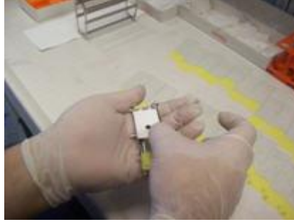
Resim 2.25: Sitoklibe filtre kartının yüklenmesi
