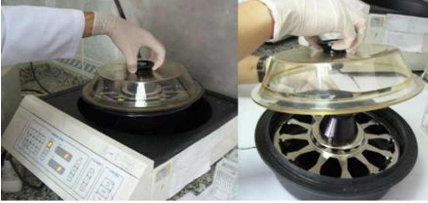
Resim 2.34: Sitosantrifüjden yalıtılmış rotorun alınması
