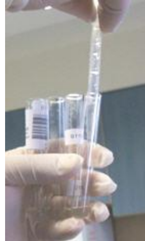
Resim 2.16: Düz tüpten pastör pipetle süpernatantın alınması
