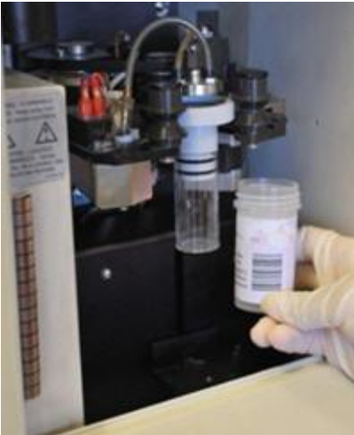
Resim 3.11: Örnek kabının cihaza yerleştirilmesi
