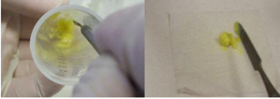
Resim 4.7: Hücre sedimentinin tüpten spatula ile filtre kağıdına nakledilmesi
