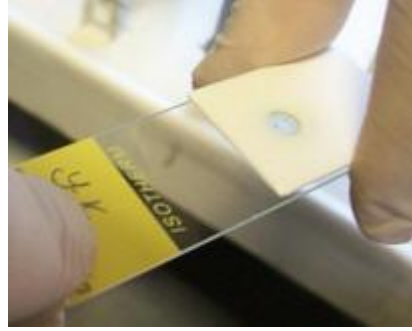
Resim 2.39: Filtre kartının lamdan ayrılması
