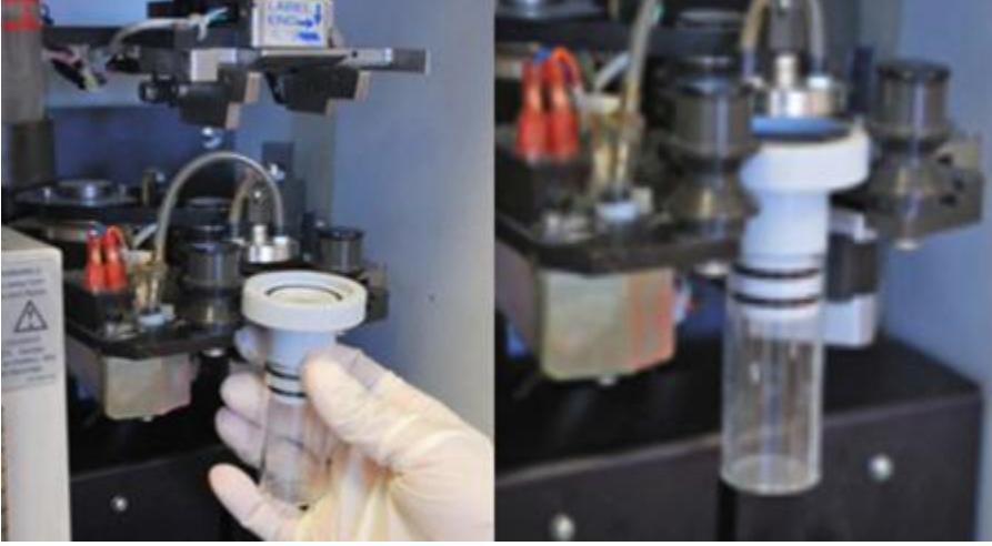
Resim 3.10: Filtrenin cihaza monte edilmesi
