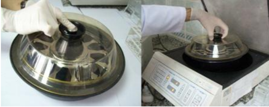
Resim 2.36: Örnek yüklü yalıtılmış rotorun sitosantrifüje yüklenmesi
