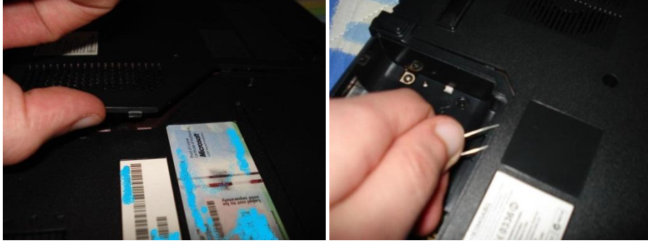
Resim 4.3: Kapak tırnaklarının açılması
