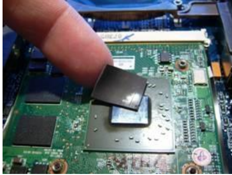
Resim 4.9: Ekran kartı ısı alan yapıřtırmaların yerleřtirilmesi
