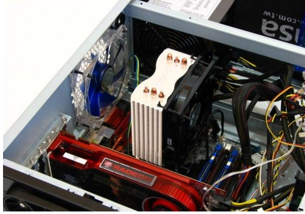
Resim 1.11: Kasa ii kabloların duzenlenmesi
