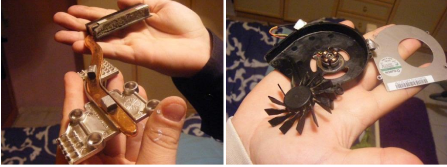
Resim 4.5: Laptop fanının sökülmesi
