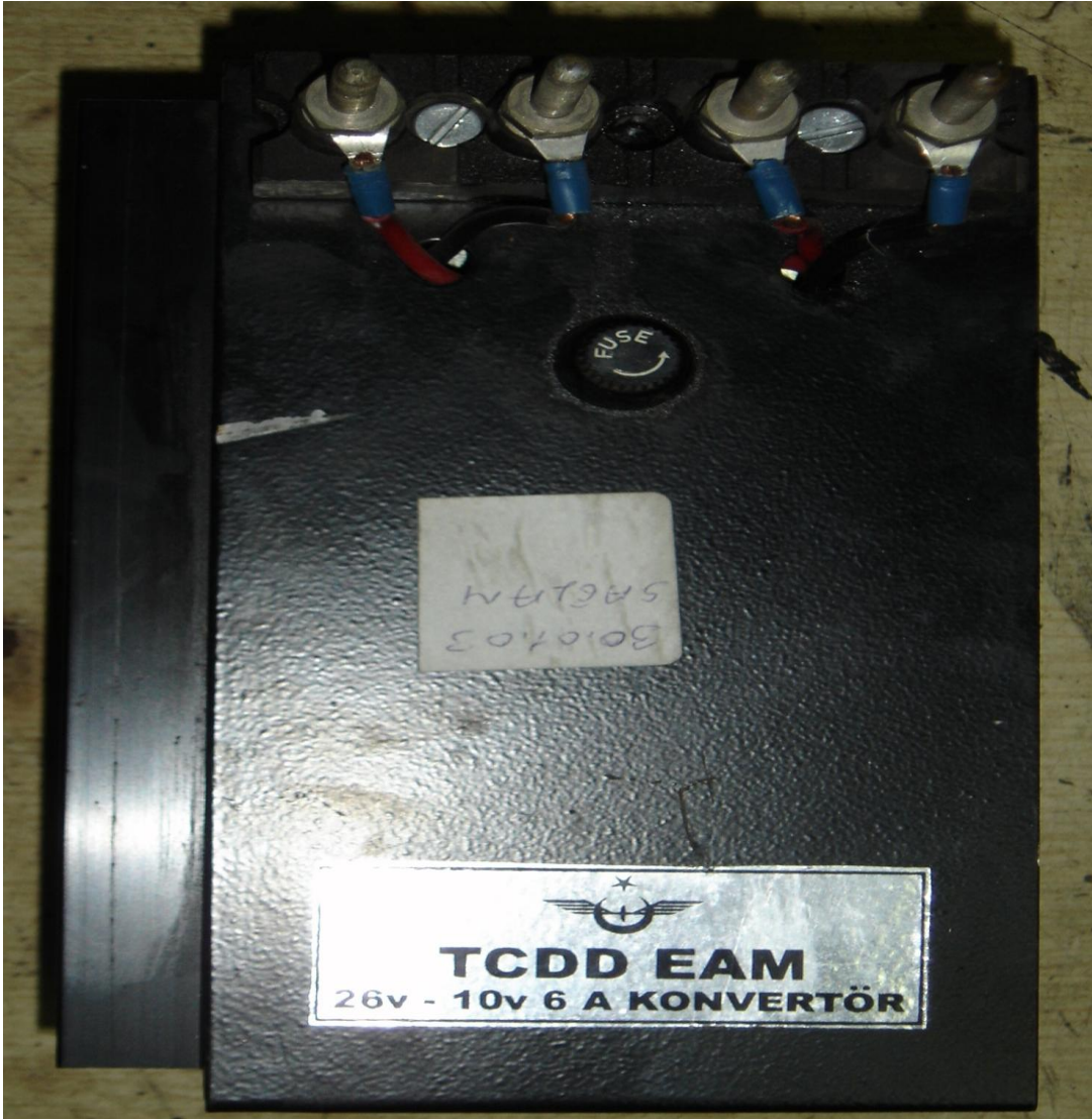
Şekil 2.3: TCDD Eskişehir katenerinde kullanılan bir konvertör
