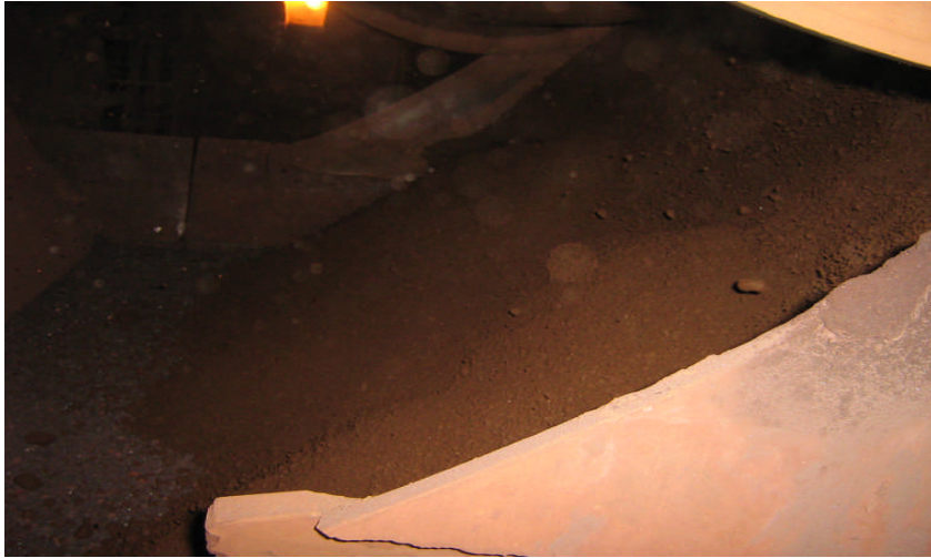
Resim 3.4: Segregasyon plakası ile cevherin yatak malzemesi üzerine serilmesi
