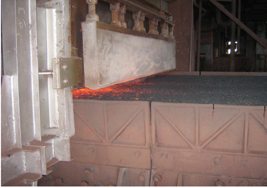
Resim 3.2: Sinter makinesi ve sinterlenme
