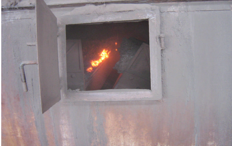
Resim 4.1: Sinterin sıcak eleğe boşaltılması
