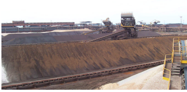
Resim 1.1: Cinslerine göre ayrı ayrı stoklanmış demir cevheri
