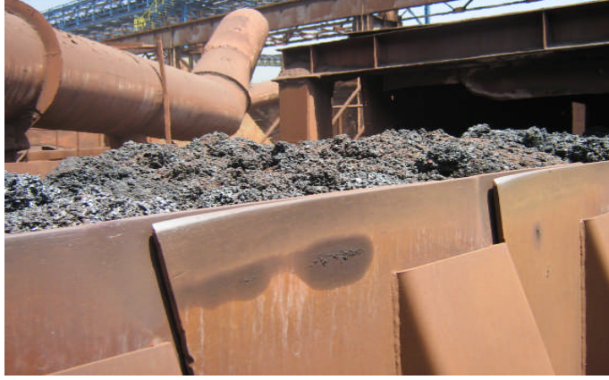
Resim 4.2: Kırılan ve soğutulan sinterin soğuk eleklerle sevk edilmesi
