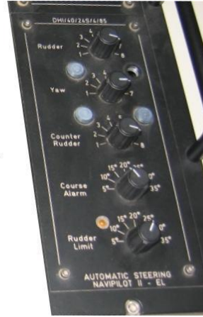
Şekil 1.8: Otopilot kontrol paneli
