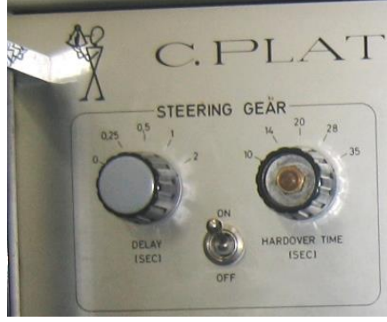
Şekil 1.2: Navipilot tester (steering gear)
