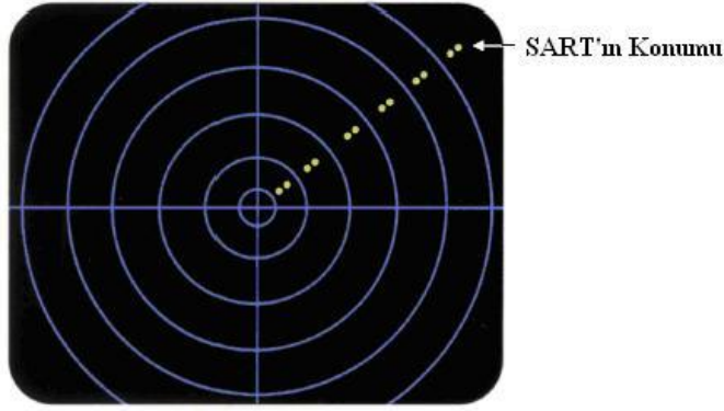
Şekil 5.2: SART sinyallerinin radar ekranında görünümü
