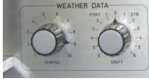
Şekil 1.4: Navipilot tester (weather data)
