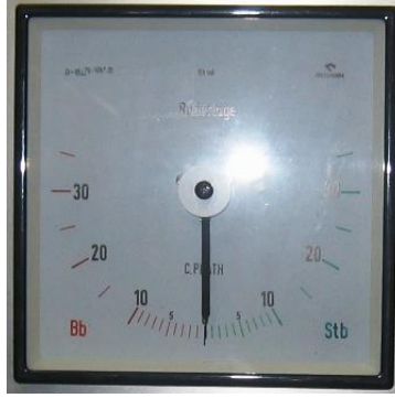
Şekil 1.7: Navipilot tester (dümen pozisyonu)
