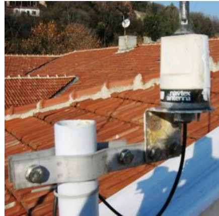
Şekil 3.1 : Navtex alıcı cihazı, güç ünitesi ve anteni
