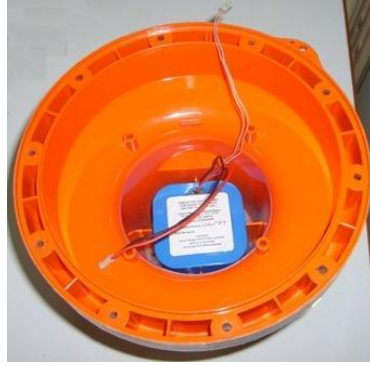
Şekil 4.4: EPİRB batarya ünitesi
