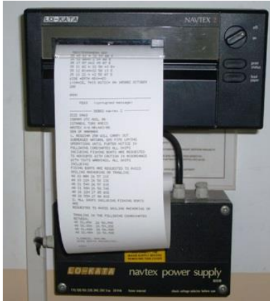
Şekil 3.1 : Navtex alıcı cihazı, güç ünitesi ve anteni
