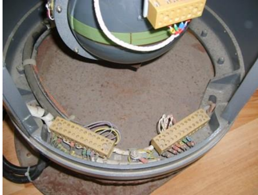
Şekil 2.9: Cayro pusula bağlantı terminalleri
