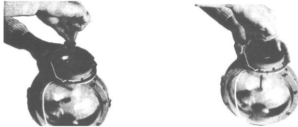
Şekil 2.7: Merkez piminin tespiti
