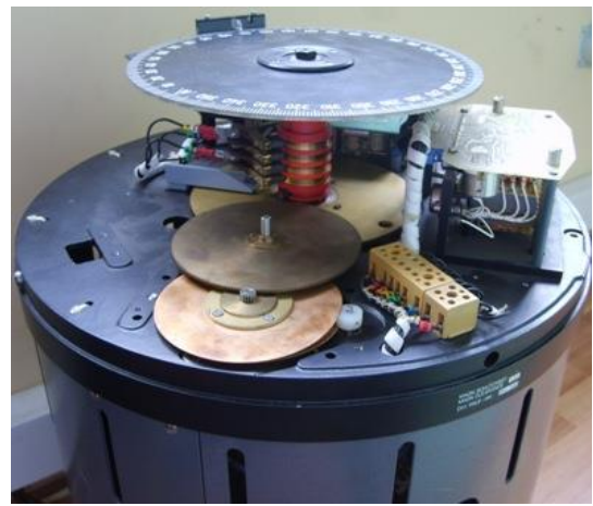
Şekil 2.2: Cayro pusula üst görünüşü
