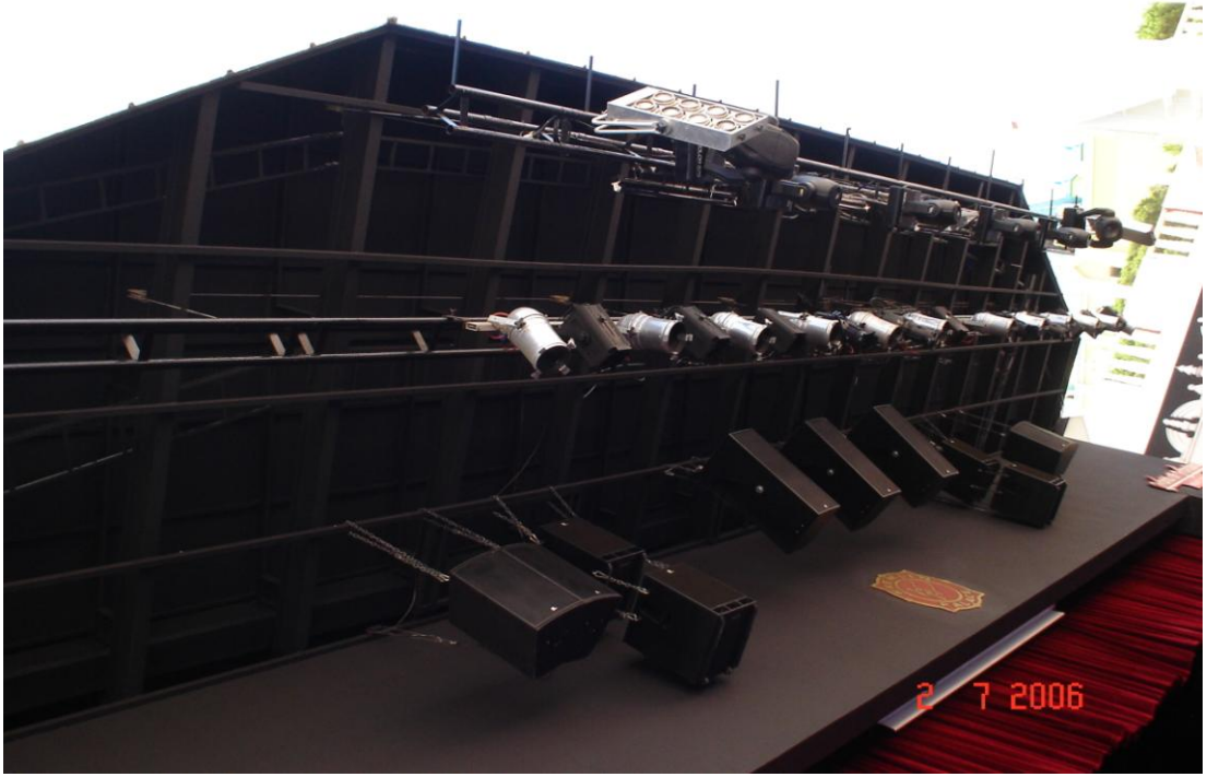
Resim 2.10: Tavana asılı spotlar, hoparlörler, döner başlıklı spotlar ve robotlardan bir görünüm
