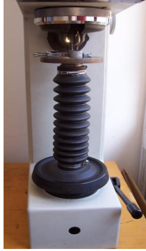
Resim 1.4: Numune üzerine yükün uygulanması
