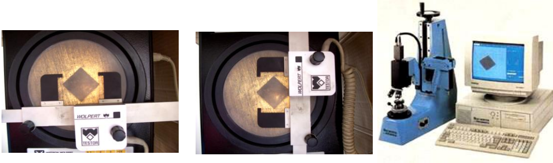
Resim 3.3: Numune üzerinde meydana gelen izin metalürji mikroskobu yardımı ile ekrana aktarılması
