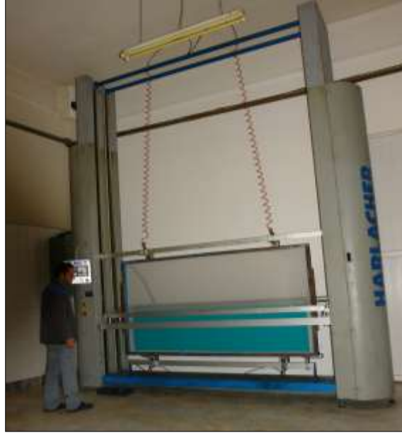
Resim 2.5: Makine ile lak çekme
