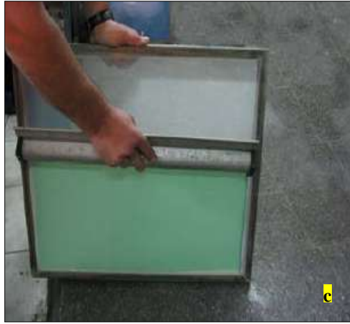
Resim 2.4: El ile lak çekme işlem adımları
