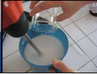
Resim 1.6: İlave pata boya ilave edilmesi
