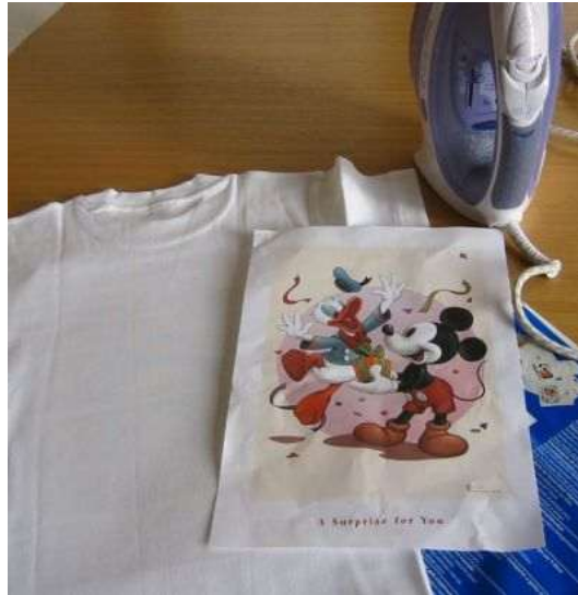
Resim 4.3: Ütü ile transfer yapımı
