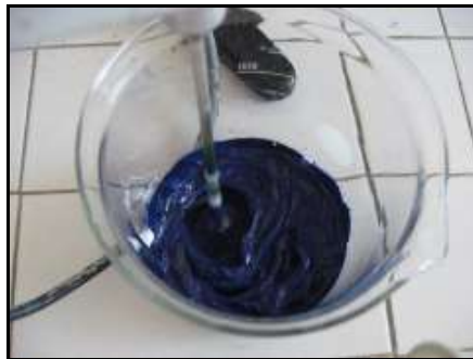
Resim 1.7: Renklendirilmiş baskı patı (kök boya, ana pat)
