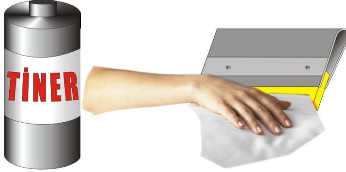
Resim 2.2: Rakle üzerindeki mürekkebin temizlenmesi
