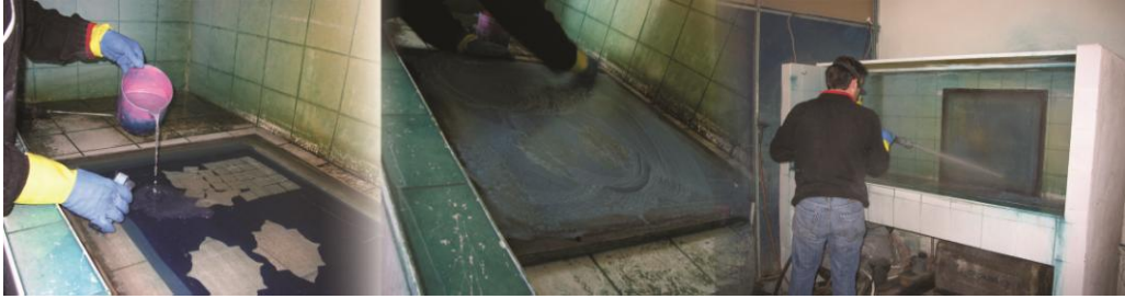
Resim 1.2: Elek üzerindeki emülsiyonun sökülmesi
