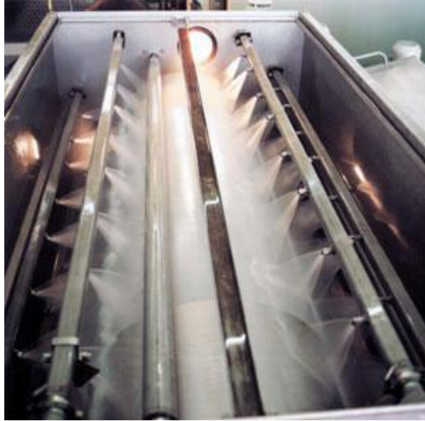
Resim 3.4: Sıcak su püskürtülerek sodyum hidroksit fazlasının uzaklaştırılması
