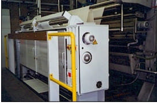
Resim 2.3: Aprelenen kumaşın flotteden çıkıp kurutmaya geçişi
