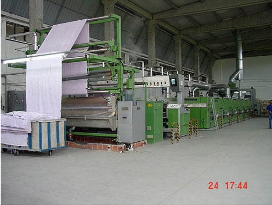
Resim 2.2: Aprelenecek kumaşın ramöz makinesine girişi
