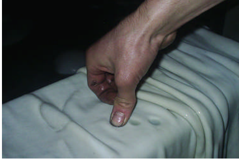
Resim 1. 3: Sama sonrası derinin başparmak testi ile kontrolünün yapılması
