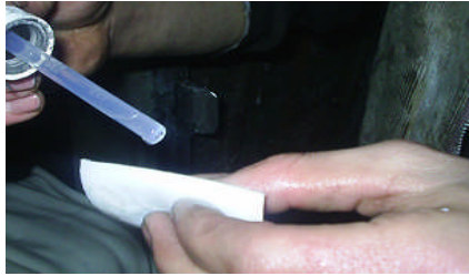
Resim 1.5: Samanın fenolftalein ile deri kesitinde kimyasal kontrolün yapılması
