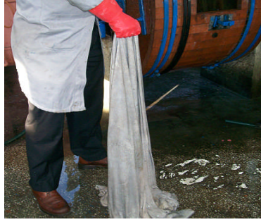
Resim 1. 4: Sama sonrası deride dökümlülük kontrolünün yapılması
