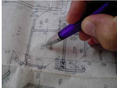
Resim 2.3: Sıva yapılacak duvar uzunluklarının alınması
