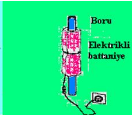
Şekil 2.24: Donmuş borunun açılması
