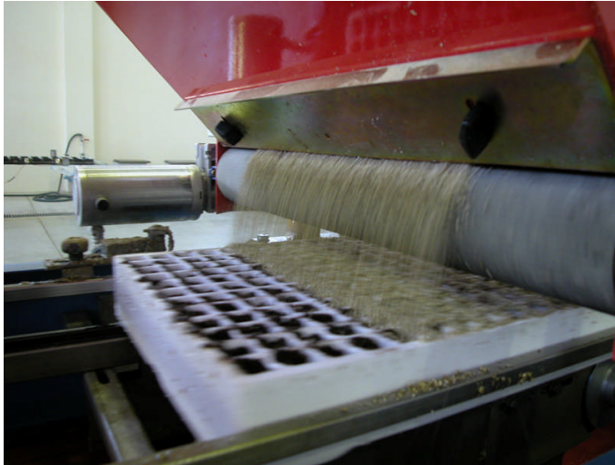
Resim 1.30: Otomatik makinede viyol dolumu
