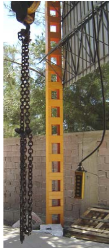
Resim 1.6: Kalıpların makineye bağlanması için kullanılan elektrik kumandalı vinç tertibatı
