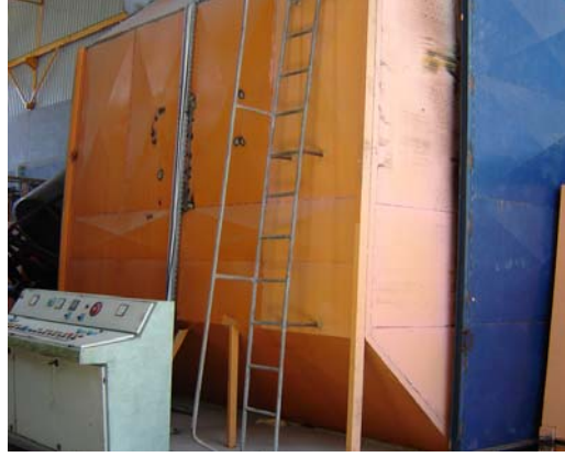
Resim 1.3: Yanma odası ve ısıtma kabini
