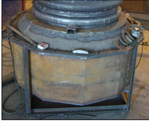
Resim 1.8: Alt bölümüne profil kaynatılmış kalıp
