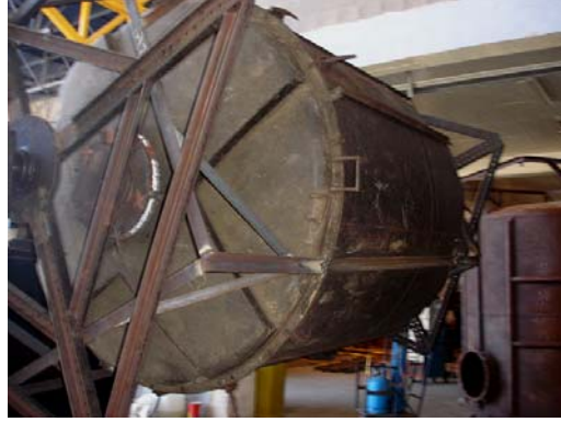
Resim 1.5: Dönen kollara bağlanmış kalıp
