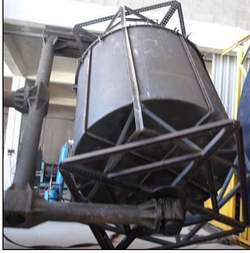
Resim 1.7: Araba kolları arasında montajlı rotasyon kalıbı
