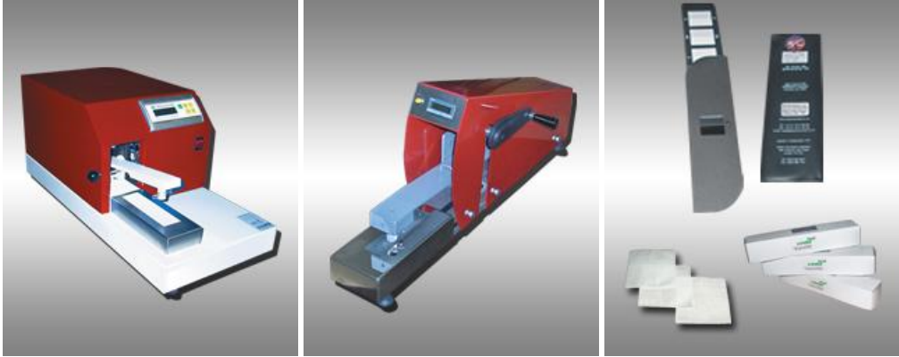
Resim 2.2: Sürtme test cihazı (crockmeter) ve gri skala örneği
