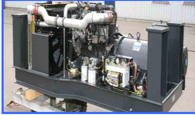
Resim 1.1: DMU 15000 tren seti yardımcı güç ünitesi
