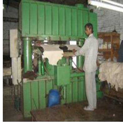
Resim 1.2: Hidrolik pres ile çalışırken cilt yüzeyinin yukarı olması
