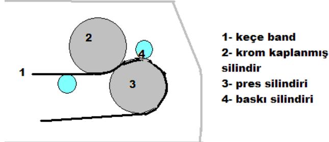
Şekil 1.2: Rotopresin parça isimleri
