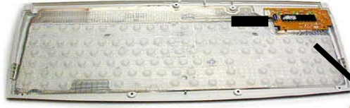
Resim 1.3: Klayenin iç yapısı
