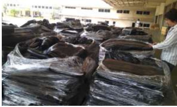
Resim 1.5: Kükürt ile vulkanize edilmiş doğal kauçuk
