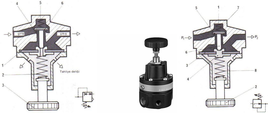
Şekil 1.18: Basınç regülatörü (tahliyeli) ve basınç regülatörü (tahliyesiz)
