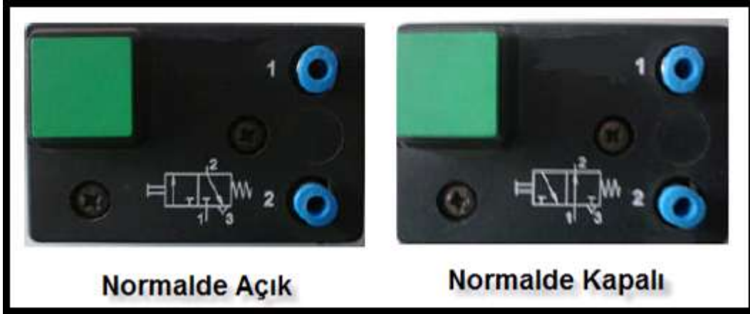
Şekil 1.5: Normalde kapalı ve açık yön kontrol vanaları
