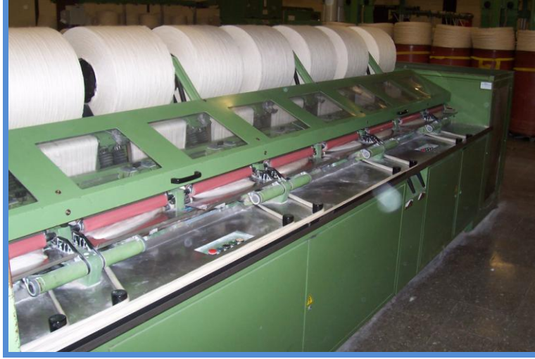
Resim 2.2: Tarama makinesinde sevk masası görünümü
