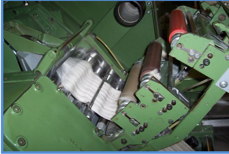
Resim 2.3: Tarama makinesinde silindirli çekim bölgesi
