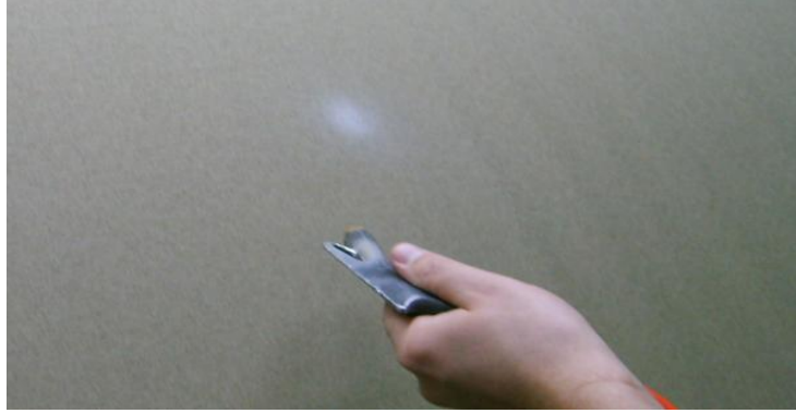
Resim 2.4: Leke çıkarıcı çözücünün kumaş üzerindeki beyaz renkli kalıntısının hava yardımı ile uzaklaştırılması
