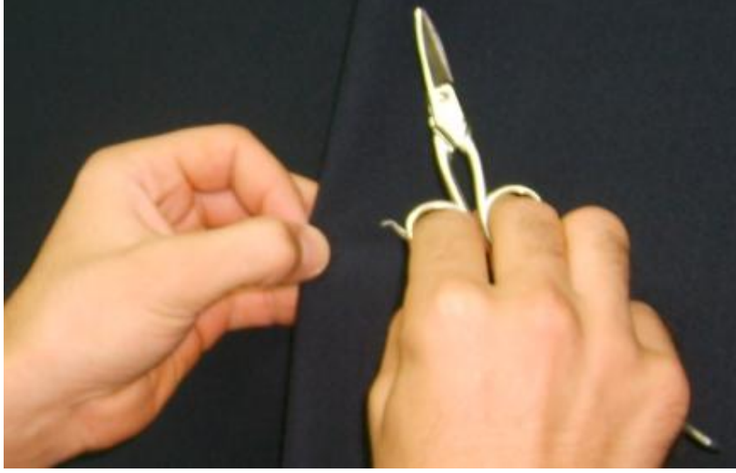
Resim 1.4: Cımbız ve el makası ile hataların giderilmesi
