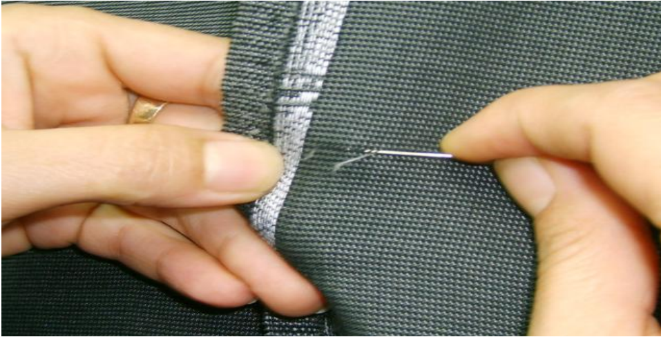
Resim 2.2: Delik hatası bulunan bölgenin iğne yardımı ile örülmesi
