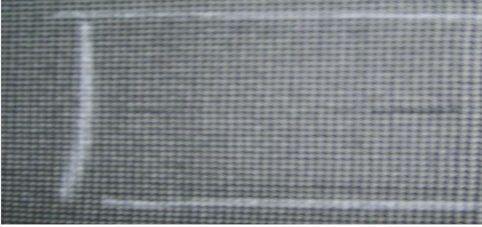
Resim 2.1: Delik hatası bulunan bölgenin ham kontrol esnasında işaretlenmesi
