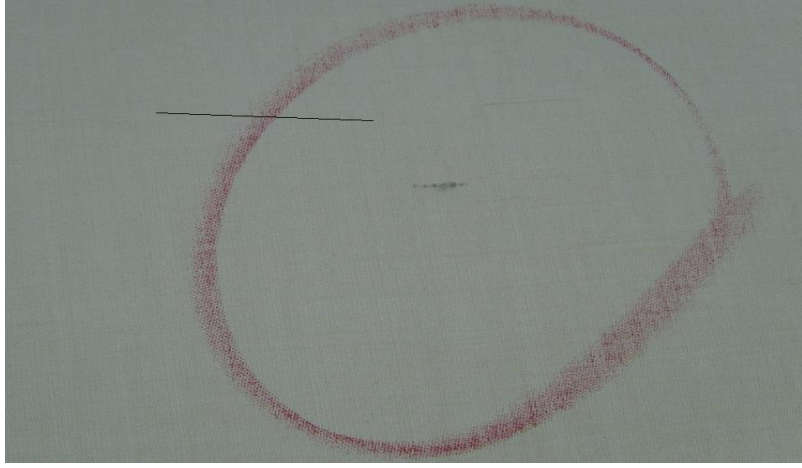
Resim 1.2: Ham kontrol esnasında hataların işaretlenmesi
