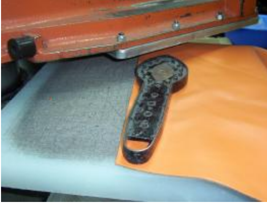
Fotoğraf 2.4: Uçluk ve tokalığın preste kesimi Fotoğraf 2.5: Gövde parçalarının preste kesimi
