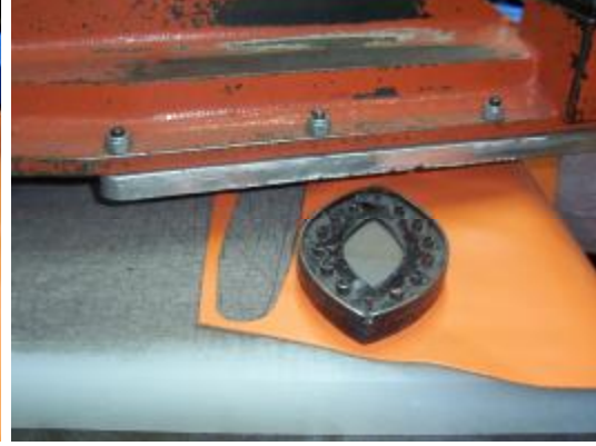
Fotoğraf 2.4: Uçluk ve tokalığın preste kesimi Fotoğraf 2.5: Gövde parçalarının preste kesimi
