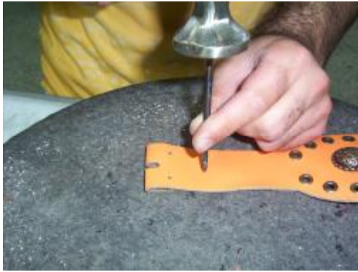
Fotoğraf 4.3: Trok deliği açma Fotoğraf 4.4: Köprü uçlarını birleştirme
