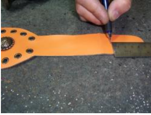
Fotoğraf 4.1: Tokalık dil yuvası işaret alma Fotoğraf 4.2: Dil yuvası deliği açma
