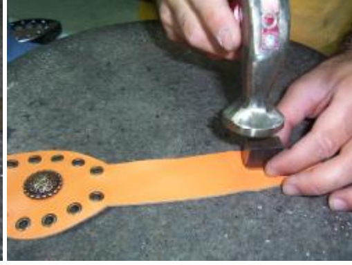
Fotoğraf 4.1: Tokalık dil yuvası işaret alma Fotoğraf 4.2: Dil yuvası deliği açma
