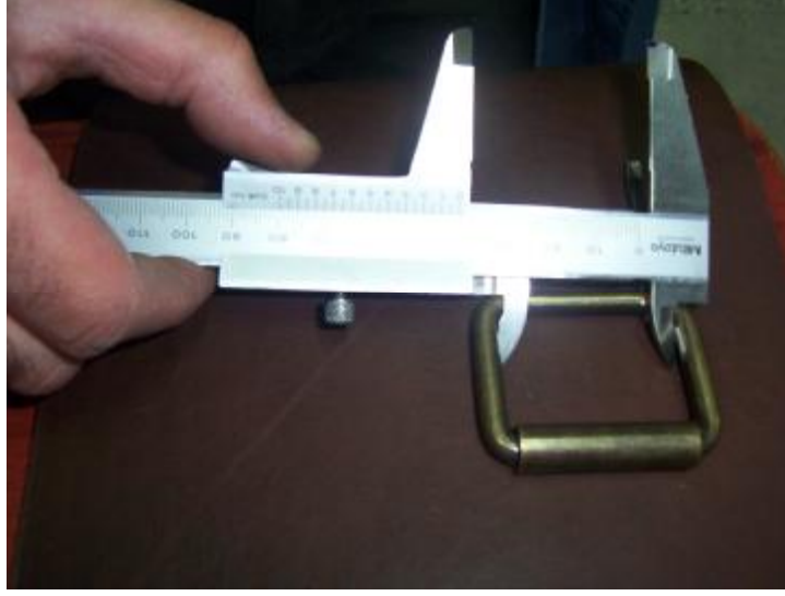
Fotoğraf 1.2: Kumpasla toka iç ölçümü
