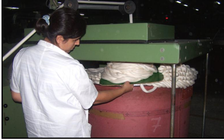
Resim 2.1: Tarak kovasından numune alma
