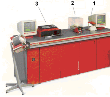
Resim 3.6:HVI 900 cihazı test ekipmanı
