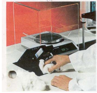
Resim 3.7:HVI 900 cihazı ile incelik ölçümü
