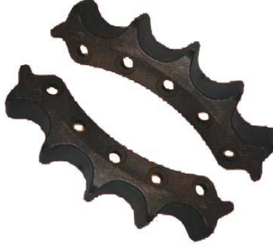
Resim 7.3: Çok parçalı rim dişlisi
