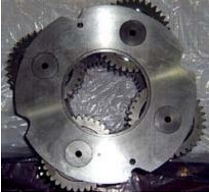
Resim 6.1: Taşıyıcı ve planet dişlileri
