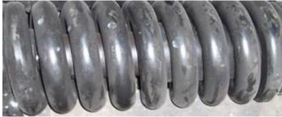
Resim 4.4: İstikamet gergi pistonu yay
