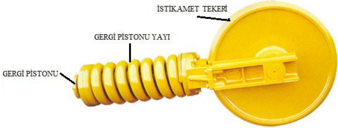
Resim 4.1: İstikamet teker sistemi
