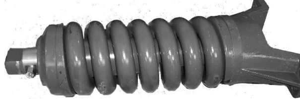
Resim 4.3: İstikamet gergi pistonu
