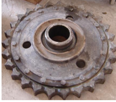
Resim 7.2: Tek parçalı rim dişlisi
