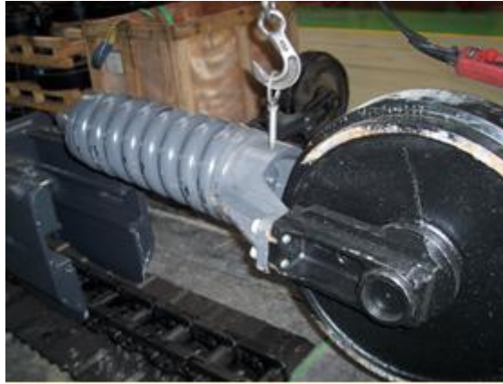
Resim 4.5: İstikamet teker sistemi
