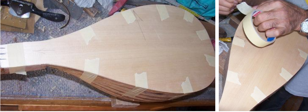
Resim 2.3: Teknenin ve ses tablosunun bantlanarak yapıştırılması
