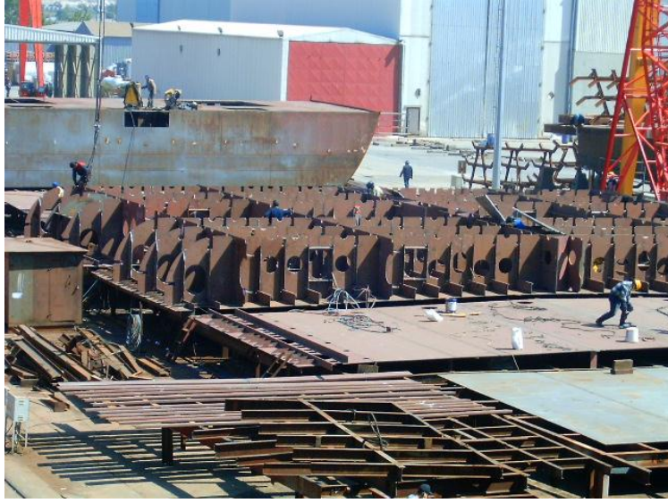
Resim 1.4: Jigler üzerinde ters olarak inşa edilen bir double bottom bloku
