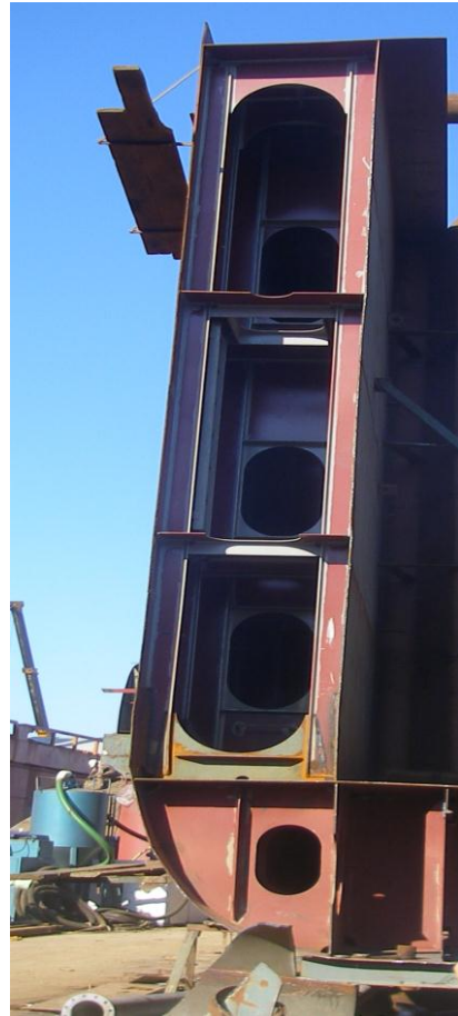
Resim 2.2: Ambar yan blokunun innerbottom sacına kaynak edilmesi
