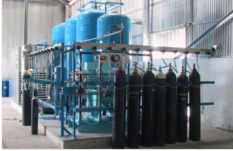
Resim 1.6: Oksijen tüplerinin doldurulması
