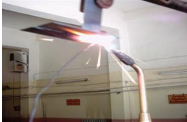
Resim 2.1: Tavan küt-ek kaynağının yapılışı
