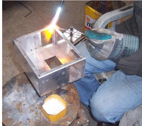
Resim 2.1: Alüminyum gerecin oksi gaz ile kaynatılması
