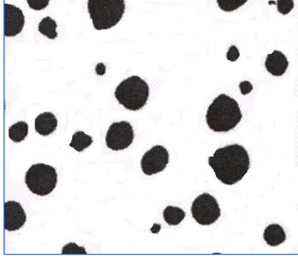
Resim 1.4: Yumuşak dökme demirin metalürjik yapısı
