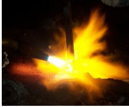
Resim 1.9: Ergiyik banyosunu oluşturma ve ilave teli karıştırarak kaynak dikişini çekme
