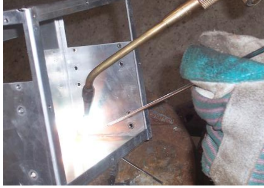
Resim 2.4: Kaynak telinin malzemeye sürülmesiyle ergime sıcaklığının tespiti
