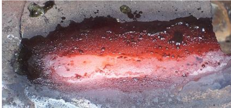
Resim 1.10: Kaynak sonrası dikişin ağır bir şekilde soğuması (Resimde görülen kaynak pastası atıkları temizlenmelidir.)
