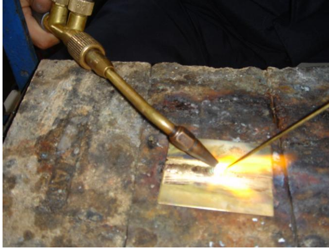
Resim 2.3: Kaynak dikişinin çekilişi
