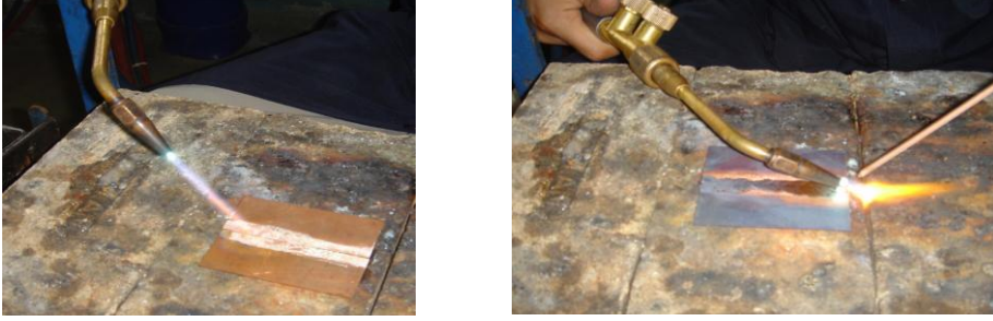
Resim 1.5: Ön ısıtma yapılışı ve kaynak dikişinin çekilişi
