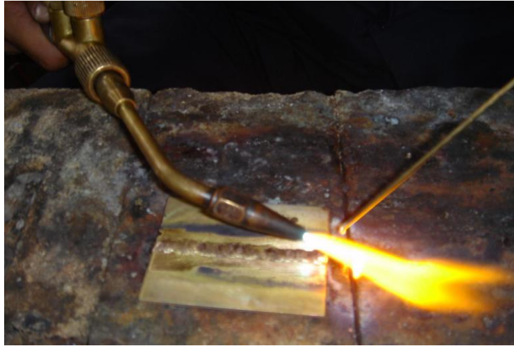
Resim 2.4: Kaynak bitiminde üfleç açısının küçültülmesi
