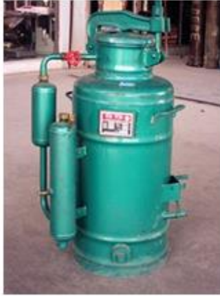
Resim 1.6: Seyyar asetilen kazanı
