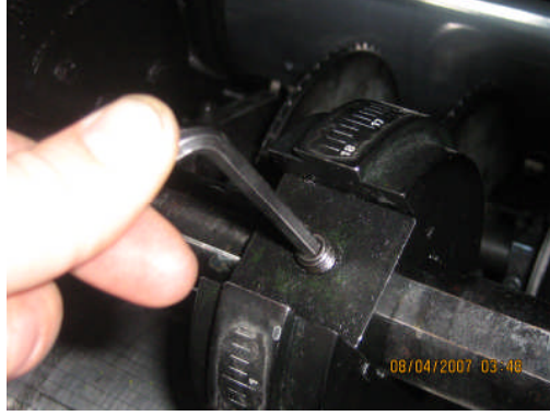
Resim 2.7:Numaratör bağlama silindiri ayarı
