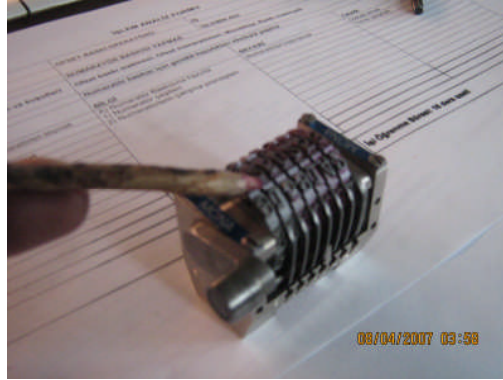
Resim 1.4: Ofset baskı numaratörü nün sıfırlanması
