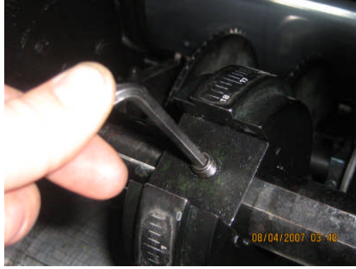
Resim 1.5: Baskı silindiri ayarı takmak
