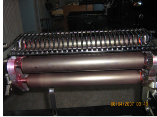
Resim 2.5: Numaratörlere mürekkep veren merdane
