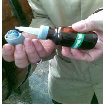
Resim 2.3: Nötralizasyon işleminin bromkresol yeşili ile kimyasal kontrolü
