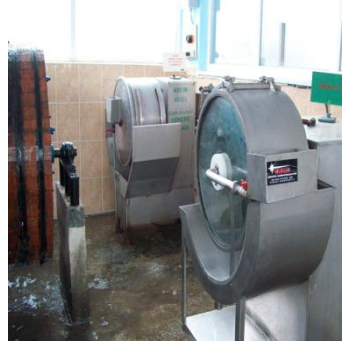
Resim 2.2: Nötralizasyonda kullanılan dolaplarının görünümü
