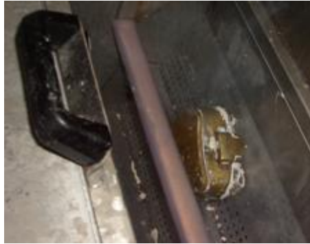
Resim 2.3: Mum eliminasyon makinesine muflanın yerleştirilmesi
