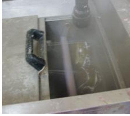
Resim 2.4: Mum eliminasyon makinesinde mum atımı
