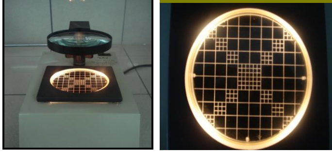
Resim 1.5: Koloni sayıcısı ve karelerin görünümü
