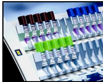
Resim 3.6: Tüpler içerisinde biyolojik indikatörler
