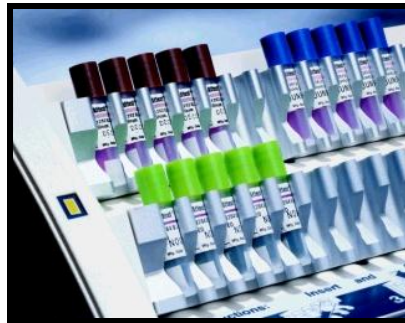
Resim 4.2: Tüpler içerisinde biyolojik indikatörler
