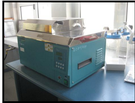
Resim 5.1: Benmarinin açık ve kapalı görünümü
