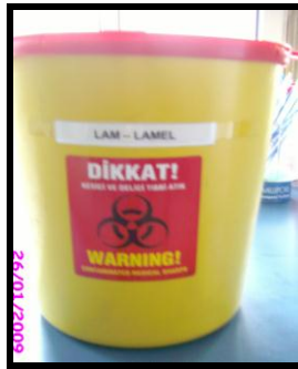
Resim 4.4: Otoklavda sterilizasyona dayanıklı kapaklı plastik kovalar
