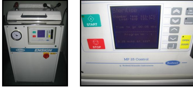
Resim 3. 2: Çalışır durumda otoklav ve göstergesi
