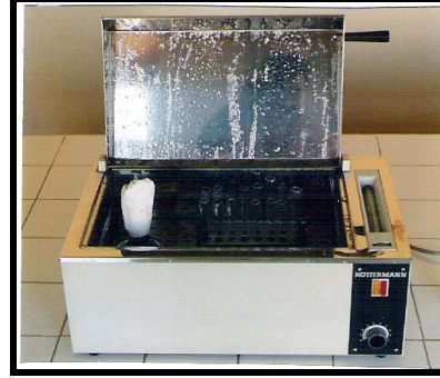
Resim 5.2: Supordaki tüpler ve cam balonun benmari içindeki görünümü
