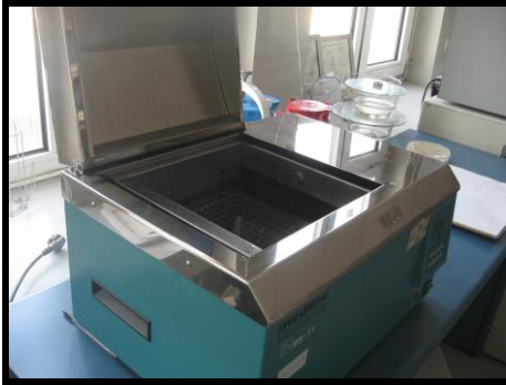
Resim 5.1: Benmarinin açık ve kapalı görünümü
