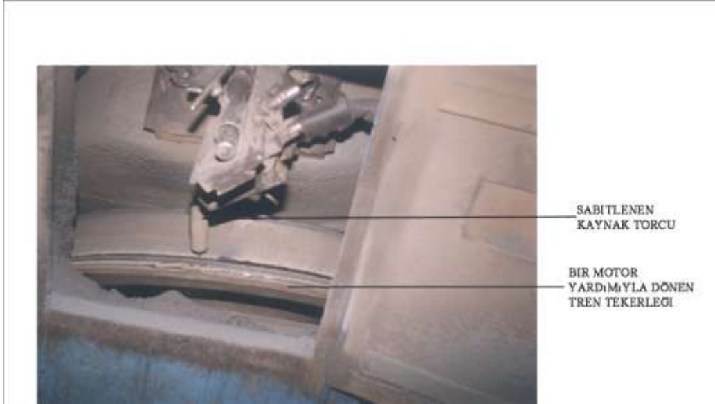
Resim 1.1: Tren tekerleğinin MIG – mag yöntemi ile otomatik olarak kaynak yapılması
