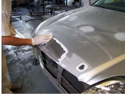
Resim 1.2: Sac astar uygulaması öncesi yüzey temizliği
