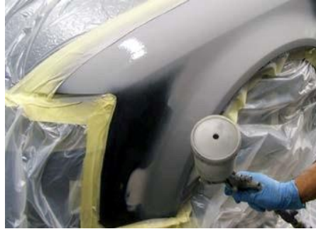
Resim 2.2: Renklendirilebilen akrilik astar uygulaması
