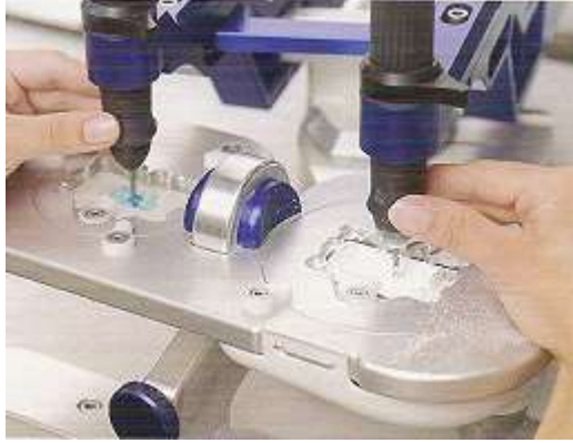
Resim 1.2: Kopyalama freze ilkesi (eş zamanlı tarama ve kopyalama)
